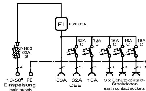
**ELEKTRA - Verteilerschrank im Gehäuse aus verzinktem Stahlblech, pulverbeschichtet RAL 6018, bestückt mit:**
