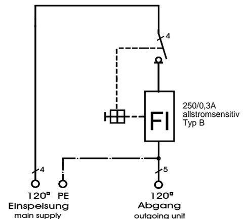
**ELEKTRA** - Kranverteilerschrank im Gehäuse aus verzinktem Stahlblech, pulverbeschichtet RAL 6018, bestückt mit:
