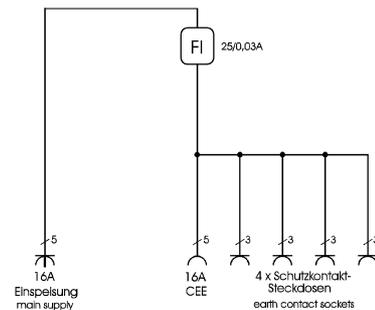
**ELEKTRA – Steckdosenverteiler im Vollgummigehäuse mit Tragegriff, bestückt mit:**
